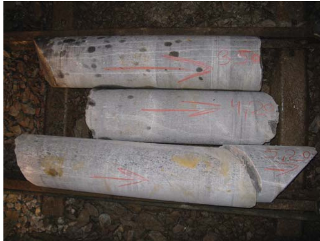
Abb. 4: Die bei den Bohrungen gewonnenen Bohrkerne des 20 Meter langen Bohrlochs weisen eine kompakte und homogene Struktur auf.
