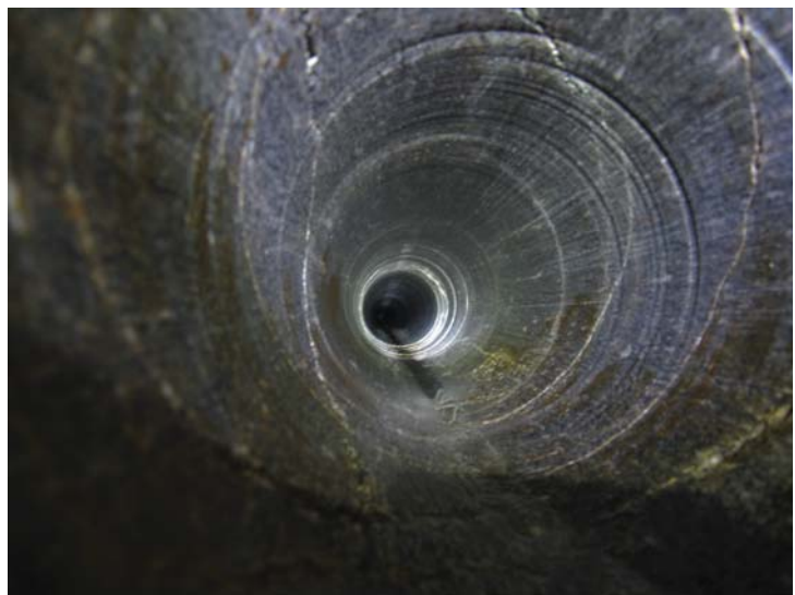
Abb. 5: Links eine der umliegenden Strecken des GFZ-Untertagelabors mit den Kammern an den Bohrlochpositionen (Foto: Grund). Die Hohlräume der Strecken bilden einen deutlichen seismischen Kontrast zum anstehenden Gestein. Das untere Bild zeigt einen Blick in eins der beiden Bohrlöcher.
