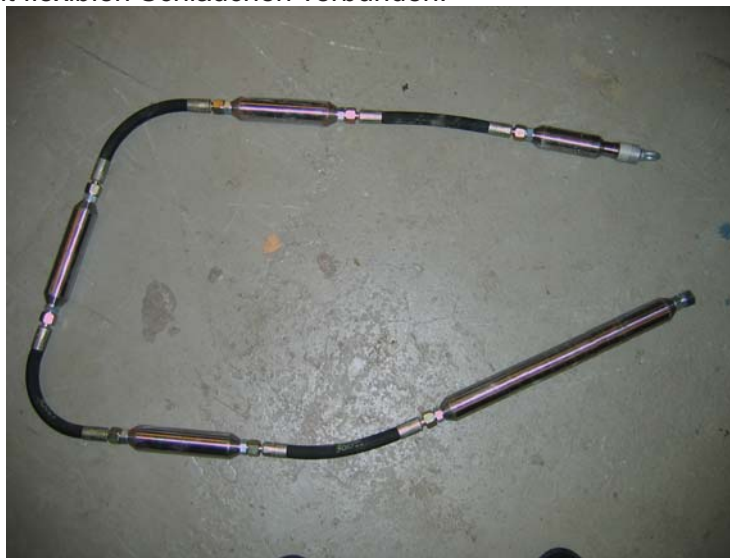
Abb.3: Konventionelle Knicksonde, wie sie in Versorgungsröhren in Schächten eingesetzt wird. Die Sonde besteht aus einem Gewichtsteil, der Datenübertragung und den Sensoreinheiten. Der Sondendurchmesser beträgt 40mm, die Komponenten sind maximal 35 cm lang, die Verbindung der Module besteht aus flexiblen Hochdruckelementen, der maximale Einsatzdruck liegt über 200 bar.
