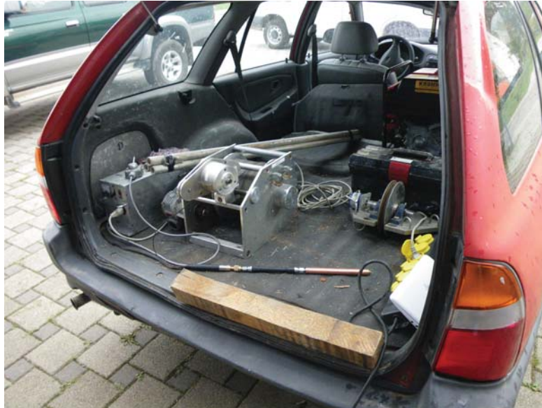
Abb. 5: Diese Abbildung zeigt die Bohrlochverlaufssonde und die verwendete Winde bei einer Testmessung. Nicht auf dem Bild ist der ebenfalls erforderliche Laptop zur Datenaufzeichnung. Die gesamte Ausrüstung kann leicht auch an schwer unzugängliche Stellen gebracht werden.
