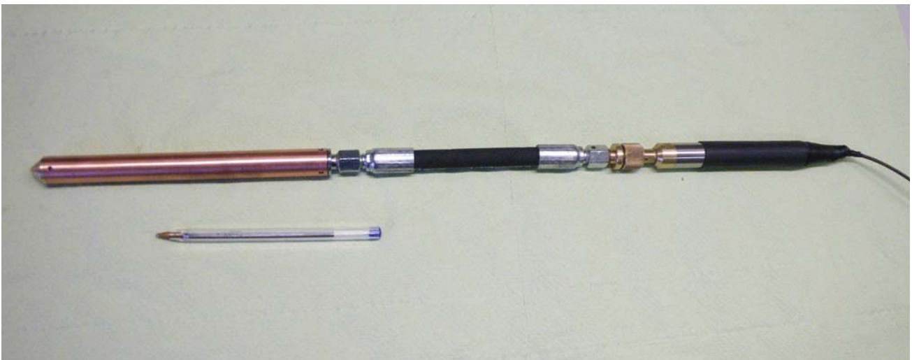
Abb. 6: Diese Abbildung zeigt die Bohrlochverlaufssonde. Als Vergleich ist ein Kugelschreiber auf der Abbildung zu sehen. Die Sonde erfüllt alle oben aufgestellten Anforderungen – Durchmesser 18 mm, Standardelemente, Modullänge maximal 20 cm.
