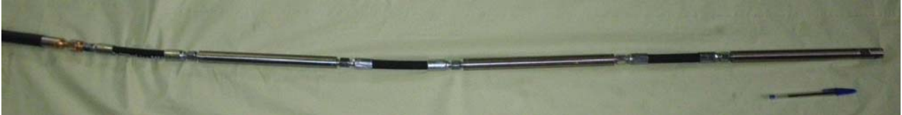
Abb. 9: Diese Abbildung zeigt die Gamma-Temperatur Sonde mit den Sensorteilen für Gamma und Temperatur, den Kupplungen und dem Kabelkopf. Als Vergleichsmaßstab wurde wieder ein Kugelschreiber verwendet.
