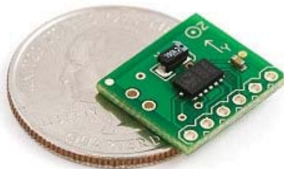
Abb. 4: Neigungs- und Richtungssensor der Firma Honeywell, wie er zum Beispiel auch in Bohrlochsonden bei DMT eingesetzt wird.
