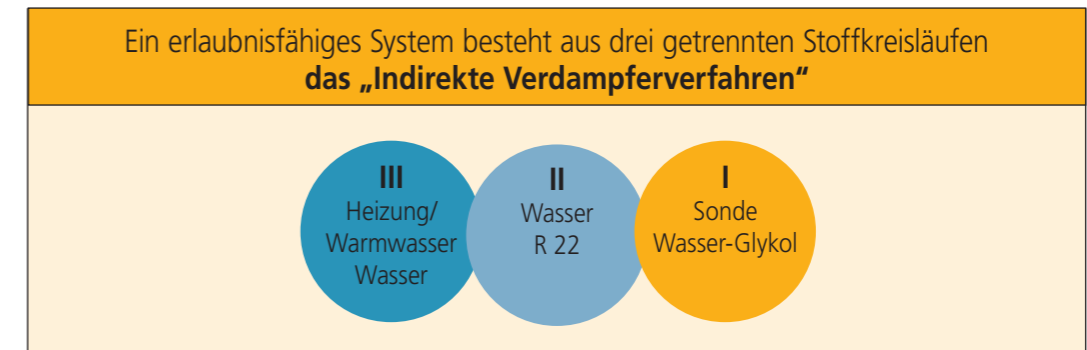
[Bild 19] System Erdwärmelanlage
