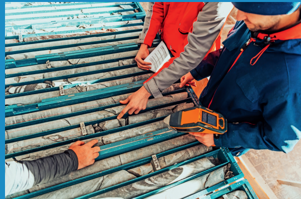
Repräsentative Bohrkern aus tiefen Bohrungen werden für die geochemische Modellierung der Gleichgewichtskonzentration an Lithium untersucht.
